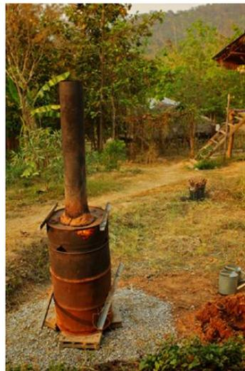
Gambar 6 dan 7. Sistem produksi gasifier biochar yang terbuat dari dua unit drum berukuran 200 liter (55 galon) dan besi bekas (foto oleh Lyse Kong)
